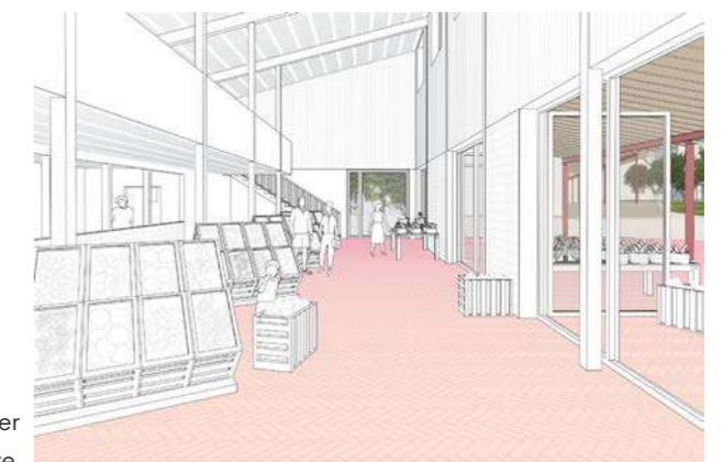
Impressie interieur refter, met doorzicht naar de overdekte buitenruimte en het dorpsplein. De keuken is compact onder de mezzanine gesitueerd en direct toegankelijk van buiten. Hierdoor is de keuken afsluitbaar en is de refter geschikt voor polyvalent gebruik.
