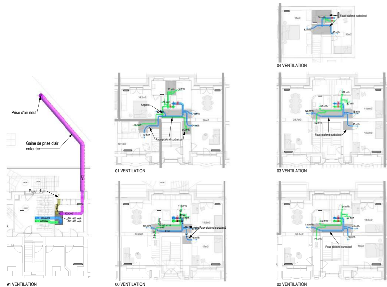
Verloop ventilatie per niveau
