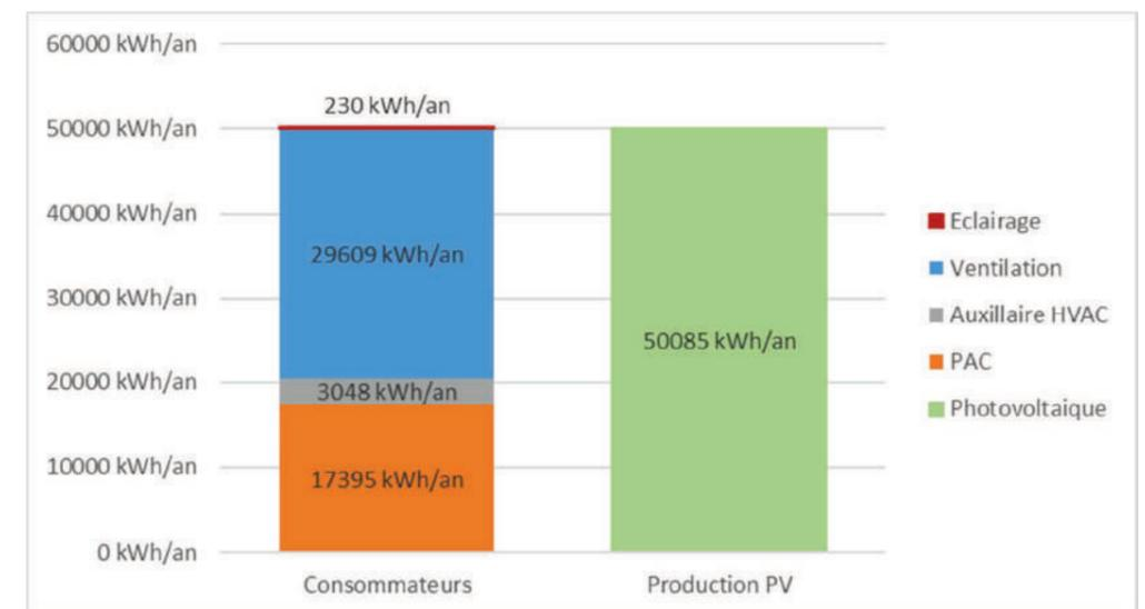
L'évaluation des consommations pour les communs (Eclairage ; auxiliaires ; Pompe à chaleur) et les logements (groupes de ventilation raccordés au compteur commun), comparée à la compensation requise en production PV nous a permis de déterminer les encombrements en toiture et les surface d'implantation requises (en accord avec les prescriptions urbanistiques)
