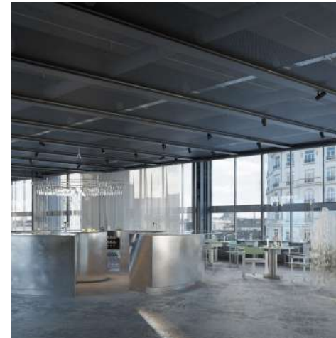
Plafond acoustique et maille métallique laissant entrevoir la structure et les techniques
