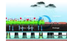
2. OPBOUW BLAUWGRÖEN DAK 2. COMPOSITION TOIT BLEU-VERT
