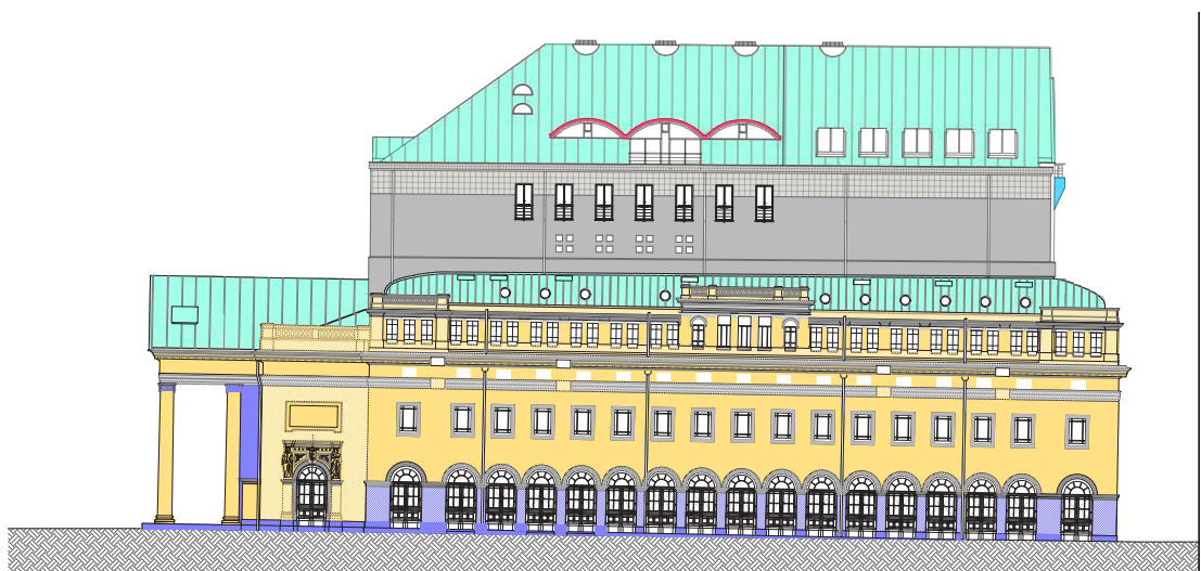
img. 17: Identification des matériaux mis en œuvre sur bas d'inspections visuelles (ORIGIN 2022) - Façade principale et façade de la rue de la Reine
