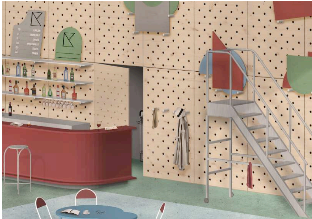
Le mur acoustique en panneaux de bois perforés, reçoit les étagères du bar et les tables de façon occasionnelle. La poutre courbée forme le bar et l'escalier réutilisé permet d'entreposer les tables.
