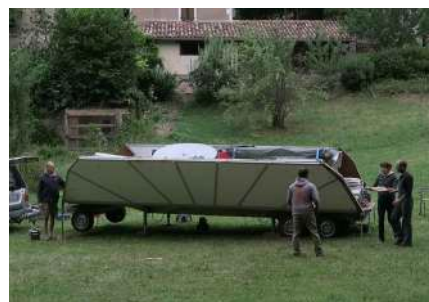
Plateau sur la remorque d’un camion se déployant pour former un chapiteau
