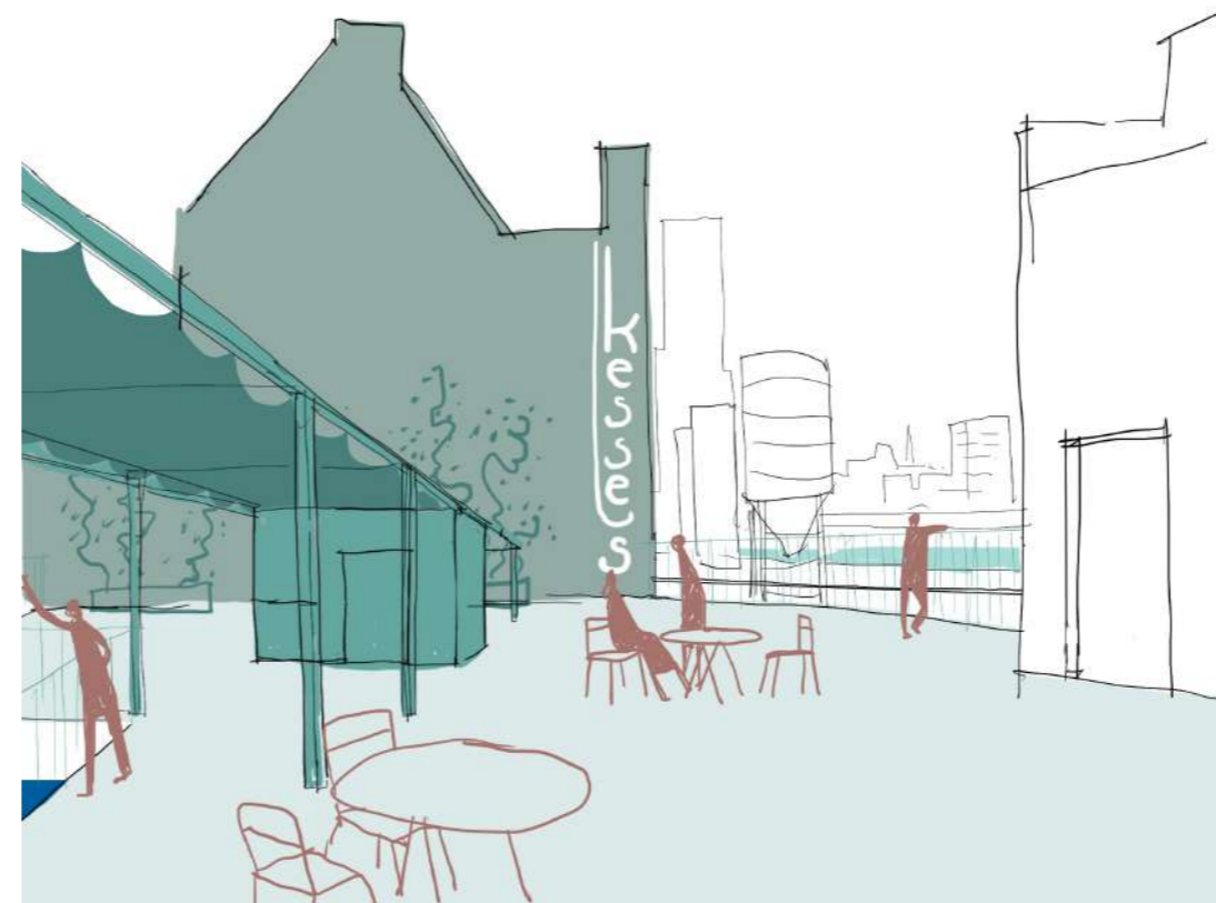
Nouvelle Maison Kessels. Terrasse rooftop Les toitures plates existantes dans l'immeuble à rue (Quai des Usines) sont reconverties en terrasse accessible pour les utilisateurs du bâtiment. Un nouvel escalier intégré dans la tourette centrale ainsi que le nouvel ascenseur donnent accès à cet espace, depuis lequel on aura des vues panoramiques sur le canal ainsi que sur le site même.
