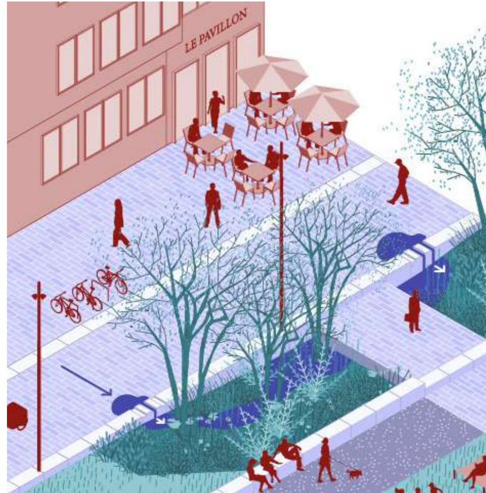
Les eaux pluviales sont redirigées vers les zones de plantation pour infiltration
