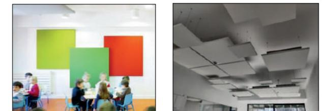
Figure 3 : Panneaux avec revêtement tissu (à gauche) et panneaux suspendus (à droite).
