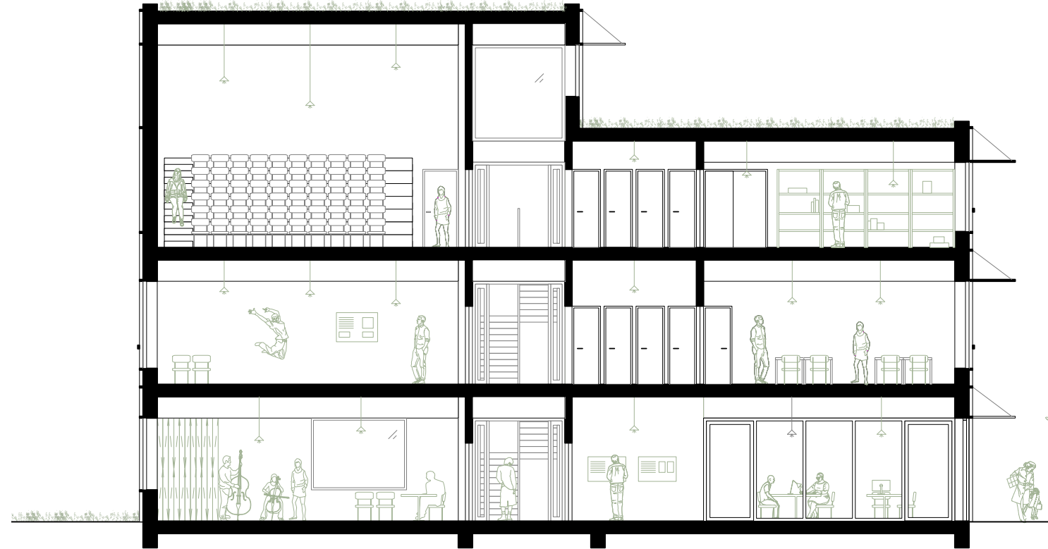
Dwarse snede door de academie, met links de grotere lokalen gestapeld, en rechts, aan de straatzijde, de meer schoolse en ondersteunende lokalen. Centraal de horizontale en verticale circulatiezone, als plek voor ontmoeting, als overloopruiimte voor de grotere publieke ruimtes en als akoestische buffer tussen de verschillende functies.
