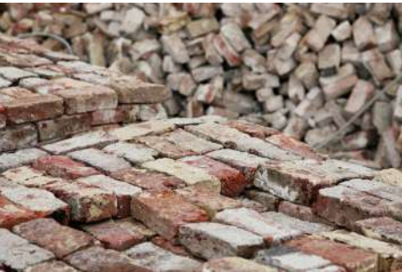
briques récupérées et nettoyées
