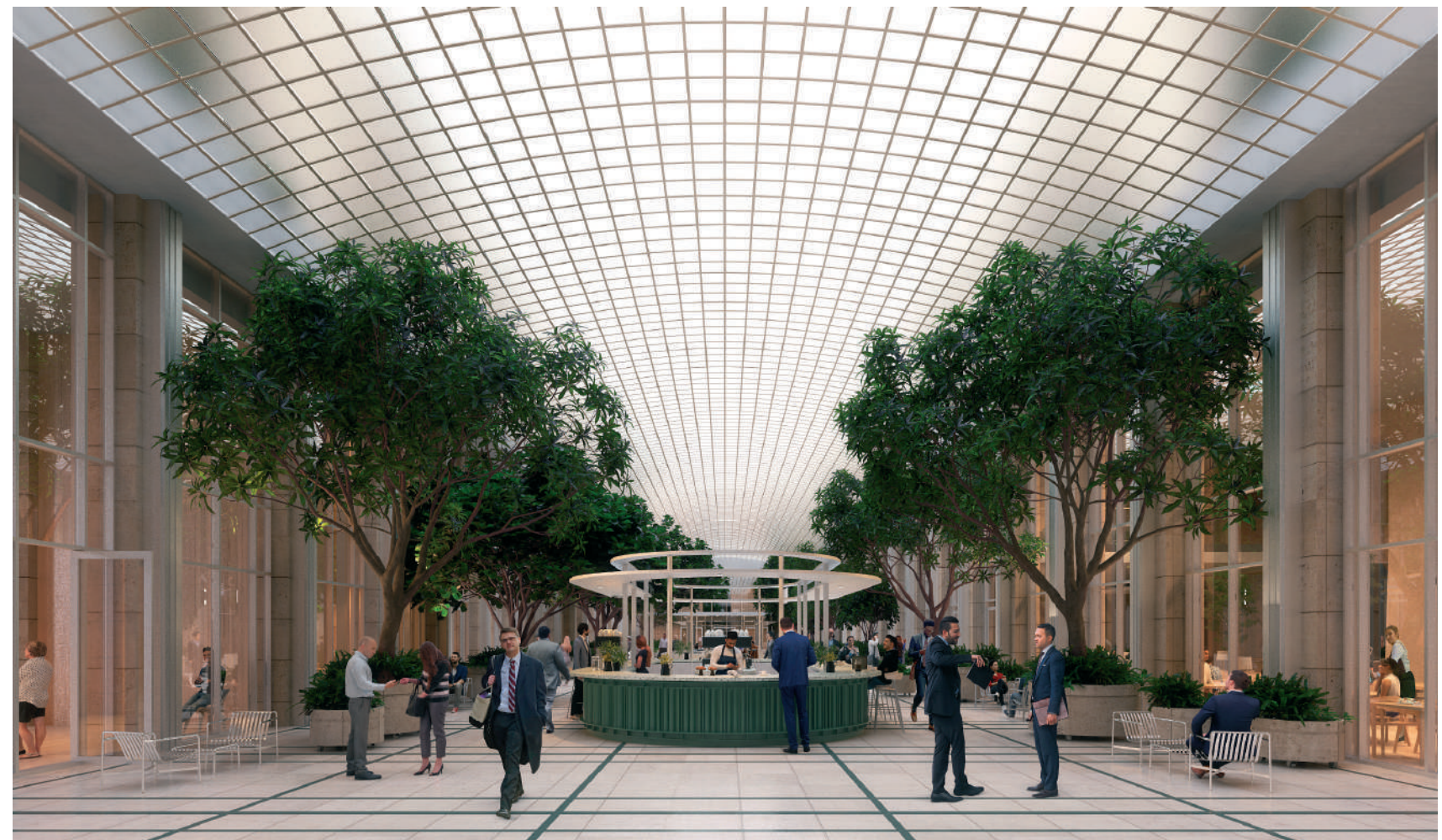
De Orangerie met centraal de Barista. De bar wordt bekleed met (gepoedercoate) bijzondere aluminium kozijnregels die worden gedemonteerd van het gebouw aan de Bankstraat en in het interieur worden hergebruikt.
