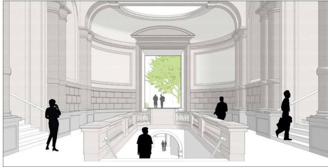
perspectief 1: verbinding openbreken monumentale trap die het Beyaertgebouw verbindt met de lokettenhal in het Van Goethemgebouw
