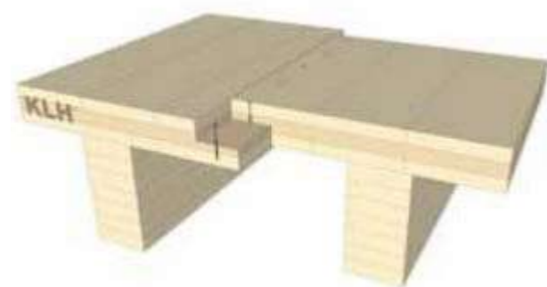
Assemblage des éléments par feuillures mi-bois
