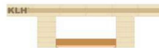
Panneau acoustique intégré entre nervures, aligné en sous-face
