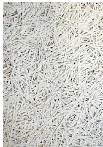
Heracliet panelen met plantaardige vezels als akoestische panelen aan de plafonds en muren.
