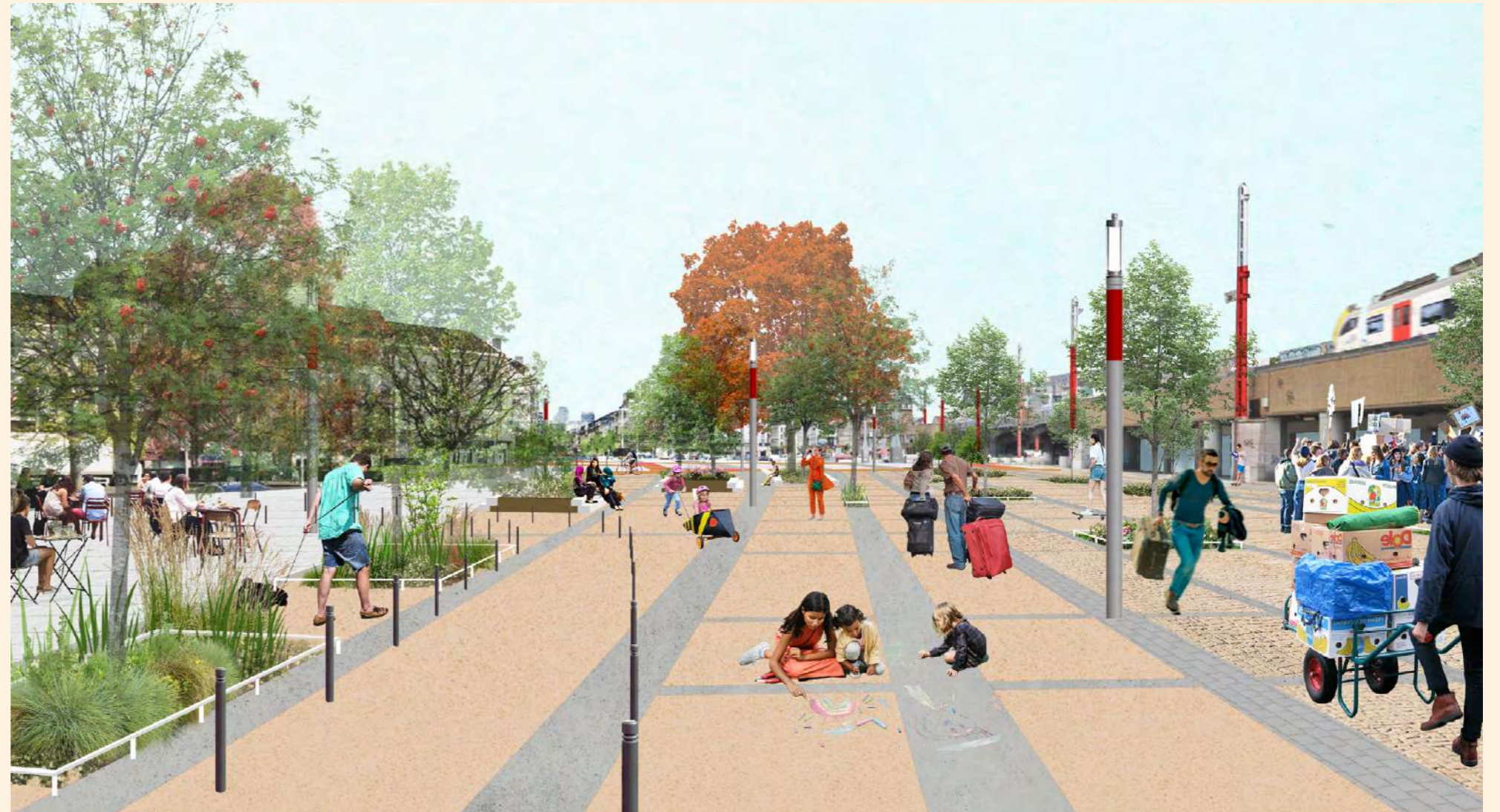
VEGETALISATION "HORS-SOL" Là où la les infrastructures souterraines sont proches du niveau de surface, des dispositifs en jardinières-assises garantissent une épaisseur de terre et substrat de minimum 1,2m pour le développement végétal. Celles-ci sont alimentées par le ruissellement.
