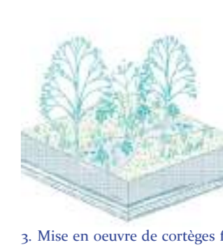
3. Apport d'une couche de remblais sains et d'une couche de terre végétale -ép. min 50 cm + amendements éventuels
