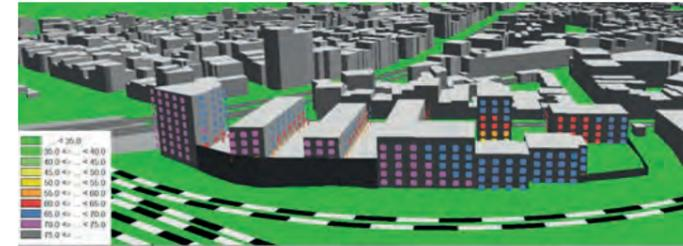
Vue 3D des cartes de bruit établies à 2m en avant des façades, côté voies ferrées – niveaux Lday
