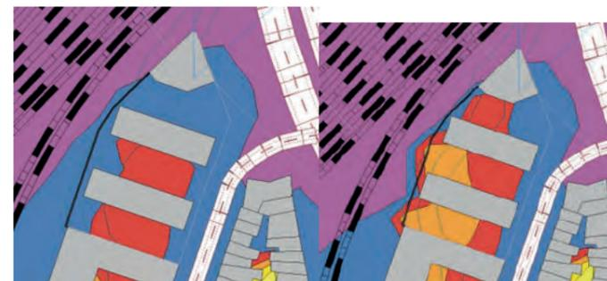
Carte de bruit LDay calculée à 1,5m au dessus du Aldi – sans mur antibruit (à gauche) et avec murs antibruit (à droite).
