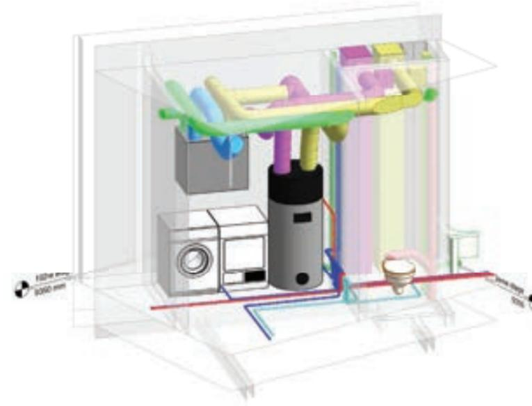
3 3D-BUANDERIE 2CH Principe de connexions d'un ballon thermodynamique
