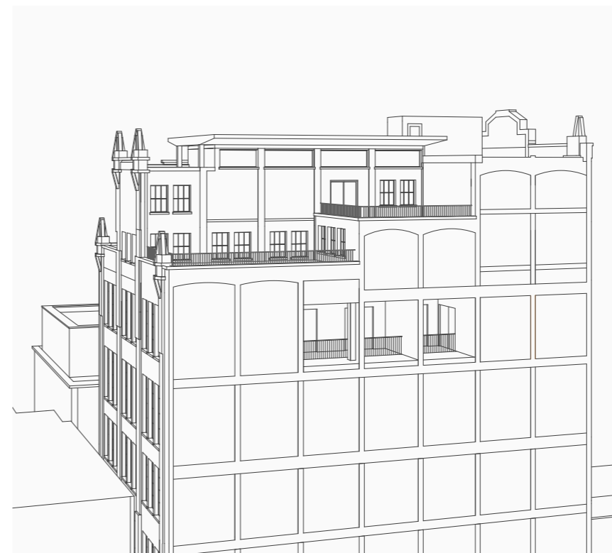
zuidgevel toren T, met openingen voor loggia'stoegang tot toren T
