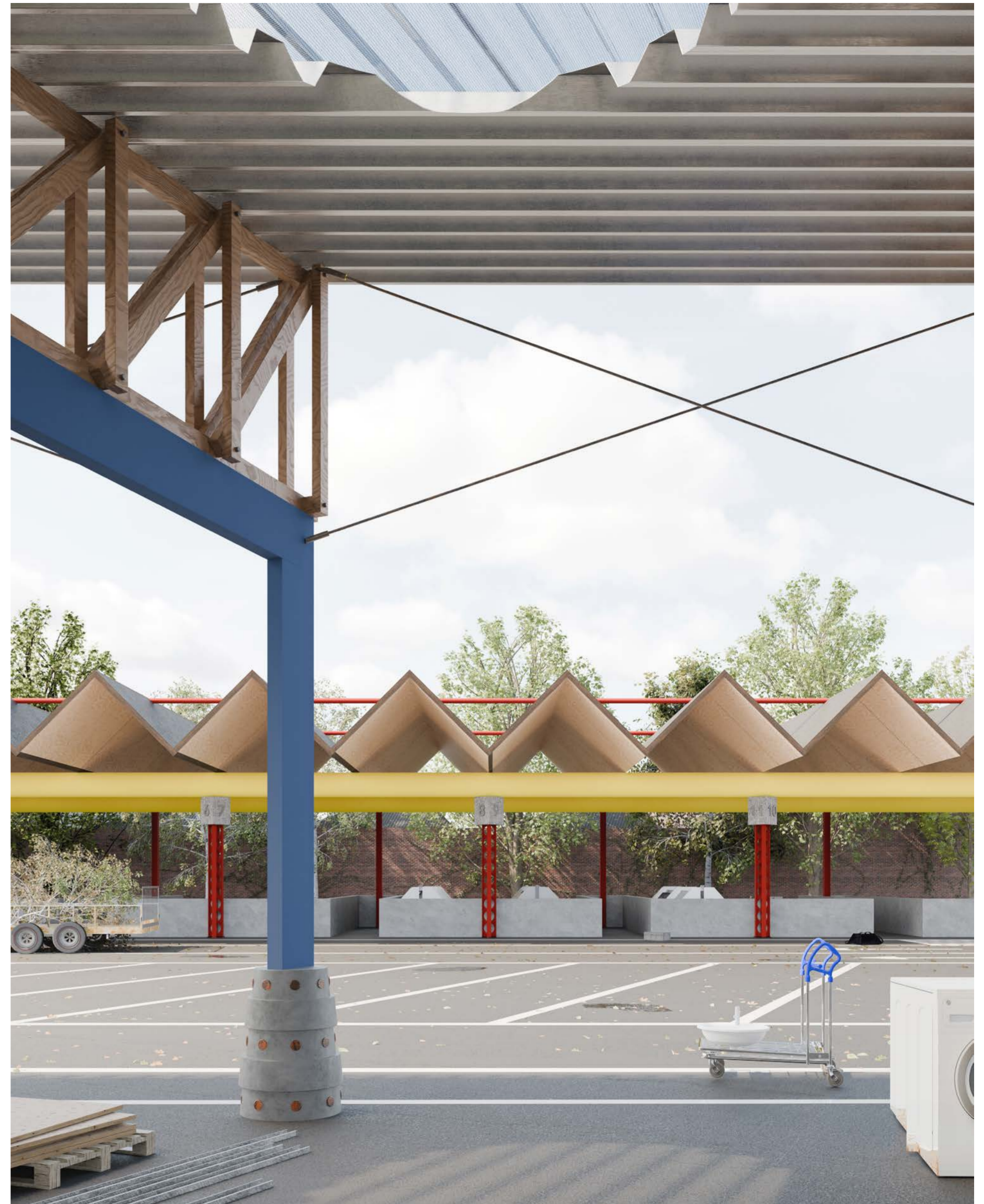
Een reeks bestaande spanten wordt opgetild door een nieuwe betonnen aanrijbeveiliging. Houten opbouwspantjes uit herbruikplanken zorgen voor een vlinderdak met vereiste vrije hoogte. Aanwezige openingen van oorspronkelijke daklichten in de steeldeck worden sierlijk uitvergroot en brengen licht binnen onder de luifel. De nieuwe luifel op de achtergrond bestaat uit houten sandwichelementen die een vakwerk vormen. Zodanig kunnen de kolommen handig geschrinkt worden geplaatst ten opzichte van de loskades en kan het dak uitragen ten opzichte van de kolommen.
