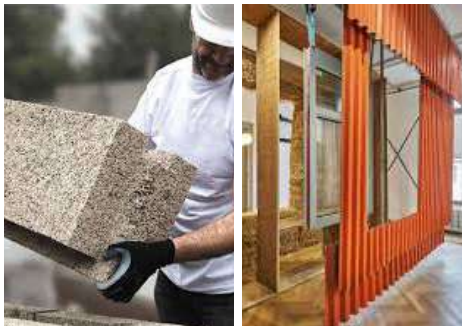
Bloc de chanvres, assemblage sec / Mock up réemploi
