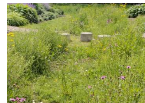
exemple de noue d'infiltration
