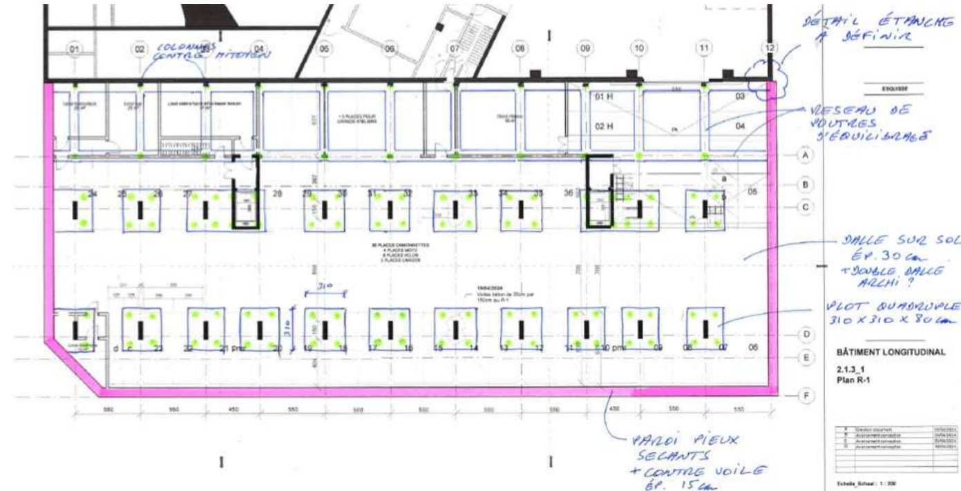
06_PLAN DE FONDATION DU SOUS-SOL
