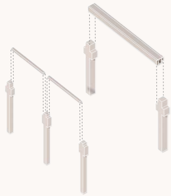
Geprefabriceerde betonnen kolommen met consoles. Oplegging staalprofiel op console betonnen kolom.
