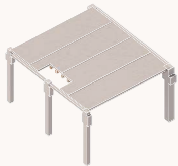
Betonplaten worden los opgelegd als roosters bovenop akoestische ont koppeling.
