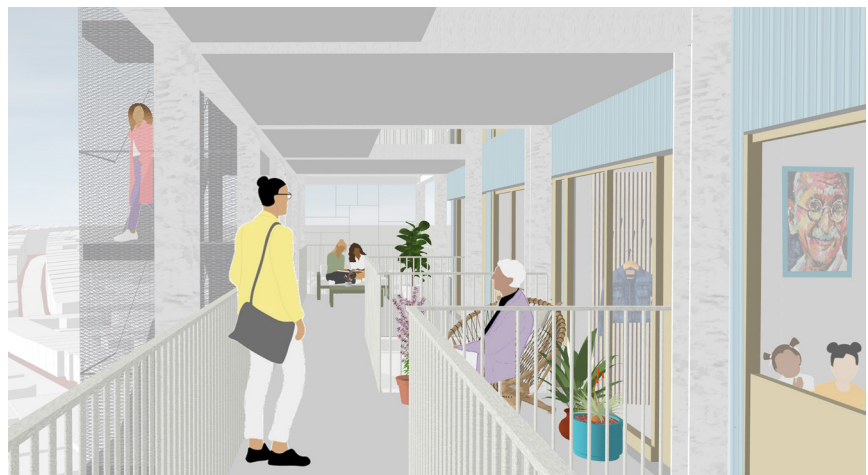
Het galerijmodel met open circulatie en individuele toegang draagt bij aan de veiligheid en gezelligheid van het gebouw.
