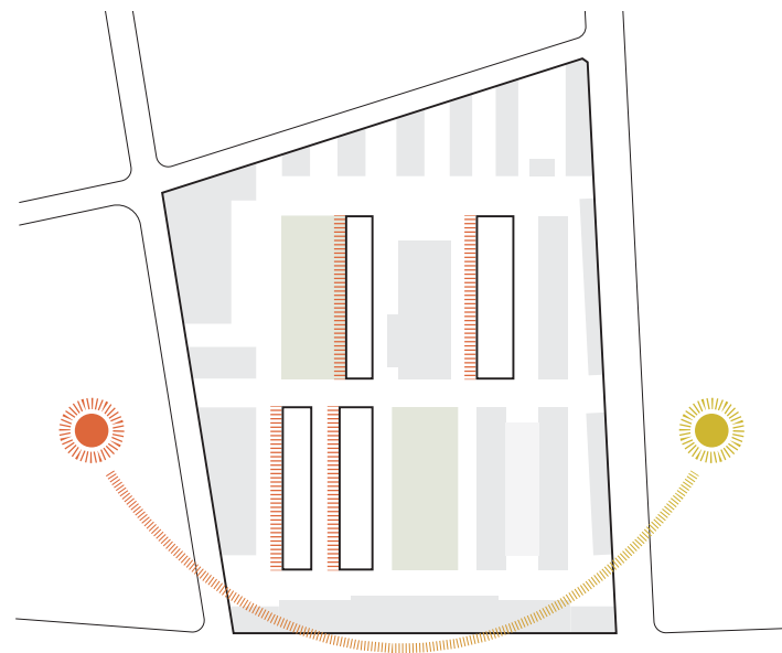
De verschillende woningen zijn zorgvuldig afgestemd op de oriëntatie van de woningen op de zon en de buitenruimtes. Hierbij worden de collectieve woonruimtes zoveel mogelijk gericht op het westen, met uitzondering van gebouw E
