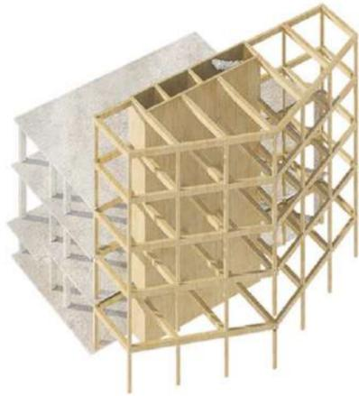
Le rapport du bureau ORIGIN précise que la descente de charge permet d'ajouter sur les fondations existantes un étage en structure lourde (accroissement des charges sur les pieux de fondation limité à 10% de la charge actuelle).
