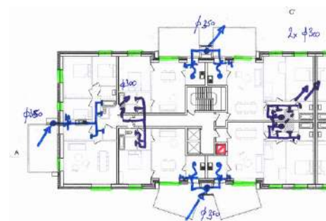
Schets van combinatie van de extractie-units zowel langs binnen- als langs buiten (Istema)
