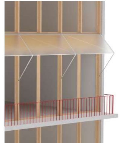
Intégration de panneaux solaires de taille standard pour l'énergie renouvelable ainsi que de brise-soleil sur la façade sud.
